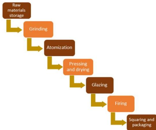
La necessaria composizione di materie prime, ivi inclusi pertanto i rifiuti riciclati, viene miscelata e macinata in impianti di macinazione tramite processo a umido o a secco.
